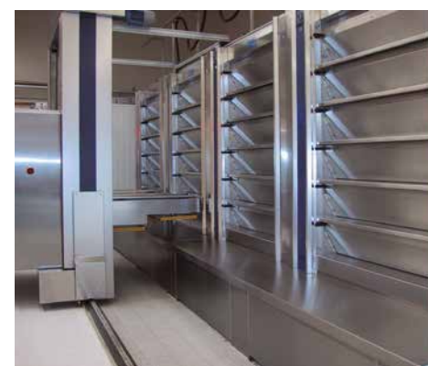
Exemple d'installation sur-mesure: 4 x HEIN ELECTRO à 6 étages avec Système automatique d'enfournement et de défournement HEIN SPIDER.
